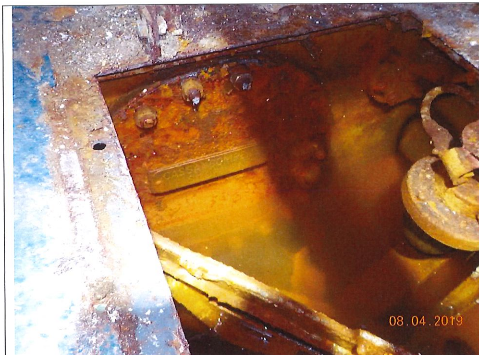
Presenza di acqua nella zona antistante la cassa compenso siluri
