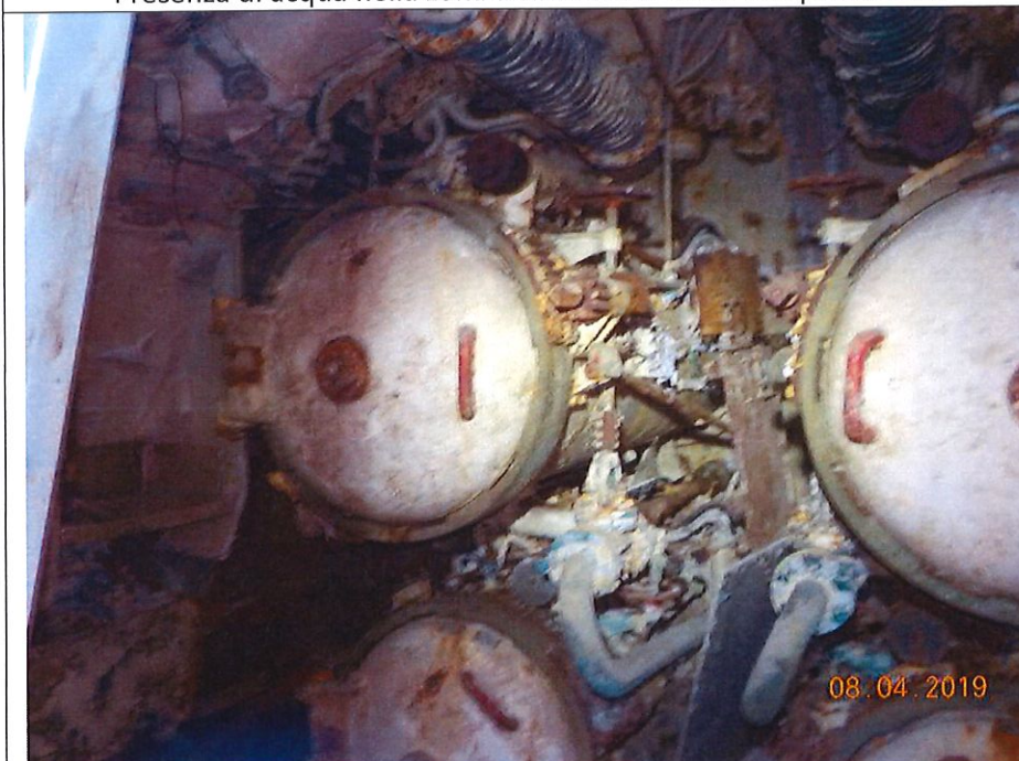
Vista dei tubi lanciasiluri e relative tubazioni
