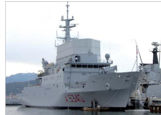
La moderna "unità per supporto polivalente" *Elettra*, impiegabile anche per attività ELINT e di monitoraggio elettronico, all'ormeggio al "Molo Varicella" dell'Arsenale della Spezia a ottobre del 2013. Si noti il personale imbarcato su un piccolo galleggiante, intento al ritocco, sulla parte bassa del mascone, della marca identificativa della posizione del "bow thruster" prodiero
